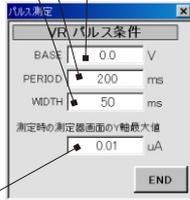
パルス測定の場合に限り、測定中の測定器画面の縦軸MAX値を指定します。MIN値はゼロです。
