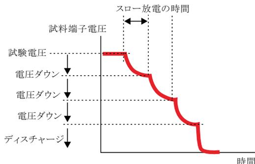
コンデンサの容量が小さい場合、スロー放電でも放電が可能です。スロー放電にチェックを付けた後、その時間を入力します。試験電圧が200V以上の場合は、少しずつ電圧をダウンし、150V以下になるまで続けます。試料の電荷がその電圧で、少しずつ5450に吸い込まれディスチャージします。この電圧でのディスチャージ処理が完了するのを待ち、次のダウンの電圧に移行します。
