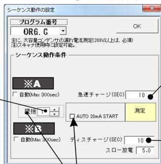
チャージ時間(充電時間)を入力します。100V以上で測定を行う場合、まず、100V/20mAで3秒充電し、その後、測定電圧に設定し、ここで入力した時間の充電を行います。このモードでは、5450のパネルにChargeの表示は最初の3秒間だけです。その後は測定モードでOPERATE-ONを維持してチャージ動作を行います。詳細のプロセスは下記図を参照ください。
