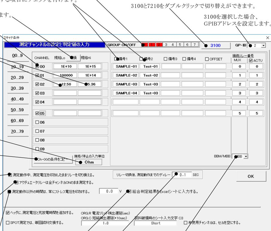
① 測定と測定の間は、OPERATEをOFFにするか、OPERATEをONにして電圧を印加し続けるかの選択を行いません。チェックを付けた場合は、測定と測定の間、印加し続ける電圧値を右の欄に入力します。このストレス電圧値は、測定に使用する測定電圧値とは別電圧です。極性切換え用アクチュエータ(下記チェック)を使用すると、マイナスの電圧が入力可能となります。
