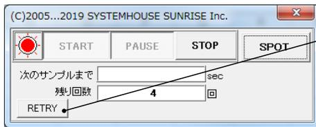
スポット測定モードで測定を行うと「RETRY」ボタンが表示されます。下記の選択で、再測定を行うことができます。
