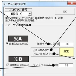
測定レンジがAUTOの場合、測定を1回を行い、その測定値は無視し、次の測定は、初回の測定値が測定できるレンジに固定し測定を行い、その測定値を使用します。初回の測定は、下記の(AUTO 20mA START)の設定に倣って行われます。
