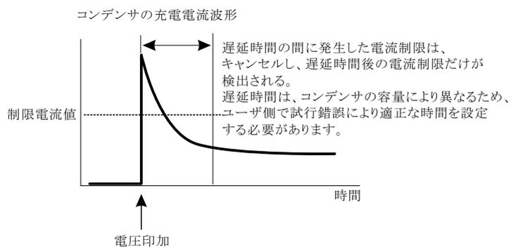
このシーケンス動作は、複数チャンネルの高抵抗値を測定する場合のスピードアップを図ることを目的としています。例えば、20チャンネルの高抵抗試料を測定する場合、各チャンネル毎に、60秒チャージと測定を繰り返すと1200秒を要しますが、このシーケンスを使用すると、60秒チャージは全チャンネル同時に行い、その後、チャンネルごとの測定を行いますから、1200秒を70秒程度まで短縮できます。スキャナを使用した測定の場合だけ、「ORG.R」を選択してください。スキャナを使用しない場合は、プログラム番号「1」を選択してください。「ORG.R」のシーケンス動作は、5450本体の内蔵機能ではなく、本ソフト側による機能です。コンデンサの測定の配線図は、18ページを参照ください。
