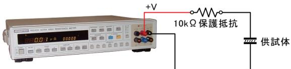
充電電圧 410V, 試料 コンデンサ (300 $\mu$ F + 10K $\Omega$  保護抵抗) \* 4個の場合
