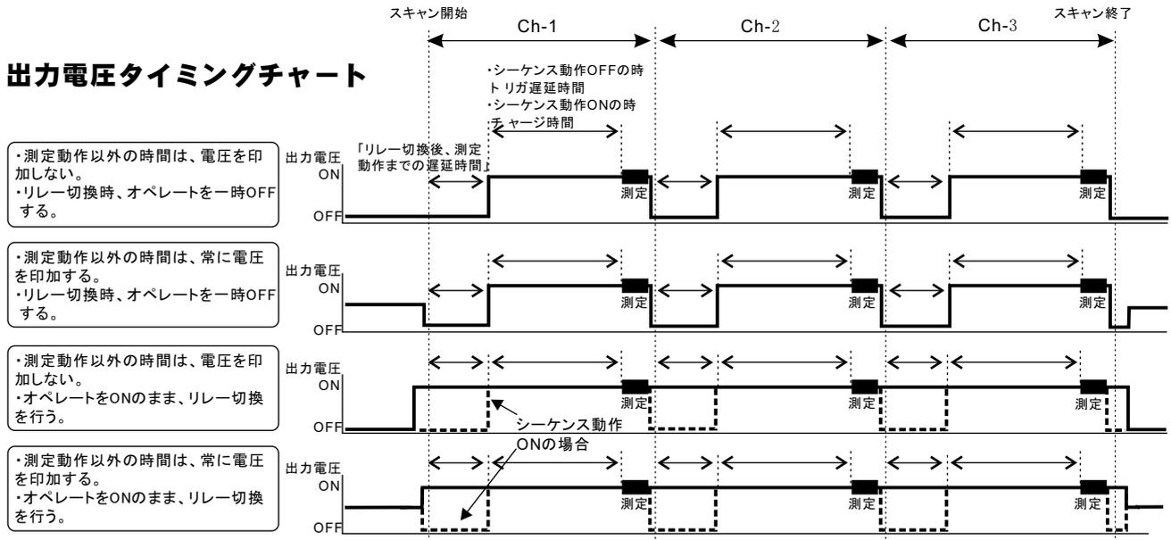
・測定動作以外の時間は、電圧を印加しない。
