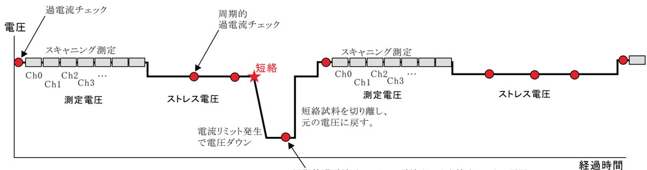
短絡試料を検出すると、測定値入力シートの1つ後ろのシートに、その情報がリアルタイムに入力されます。
