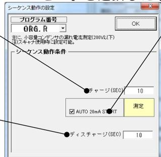
測定レンジが、AUTO-RANGEに設定されている時、測定直前に、一旦、20mAレンジに設定し、その後、AUTO-RANGEに戻してから、測定を行います。測定レンジが、AUTOではない場合、この設定は無視されます。
