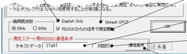
チェックを付けたら、「START」ボタンをクリックした後、RS232Cの受信データで測定開始が可能になります。RS232Cの受信データ待ちの時、「SPOT」ボタンでも測定を開始できます。
