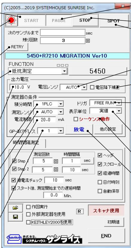
データの取込を一時中止します。もう一度クリックすると、取込を再開します。
