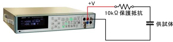
充電電圧 410V, 試料 コンデンサ (300uF + 10KΩ 保護抵抗) \* 4個の場合
