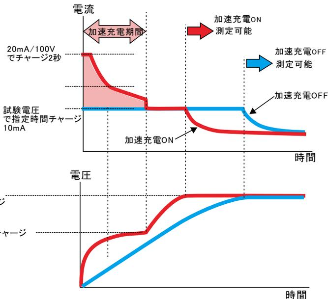
コンデンサの測定を行う場合、チャージの自動にチェックを付けることを強くお勧めします。試料(コンデンサ)のチャージ時間が予測できない場合は、自動にチェックを付けます。5450の電流制限が解除されるまでの時間をパソコンが自動的に管理します。この場合のチャージ時間は、電流制限が解除されてから、測定開始時間までの遅延時間を意味します。電流が安定するまでの時間をチャージ時間として入力します。(詳細は次ページを参照)自動にチェックを付けると、最大待ち時間の入力画面が表示されますから、十分長い時間を入力します。自動チャージモードで、この最大待ち時間を経過しても充電が完了しない場合、警告画面が表示されますから、継続するか、中断するかを指示します。
