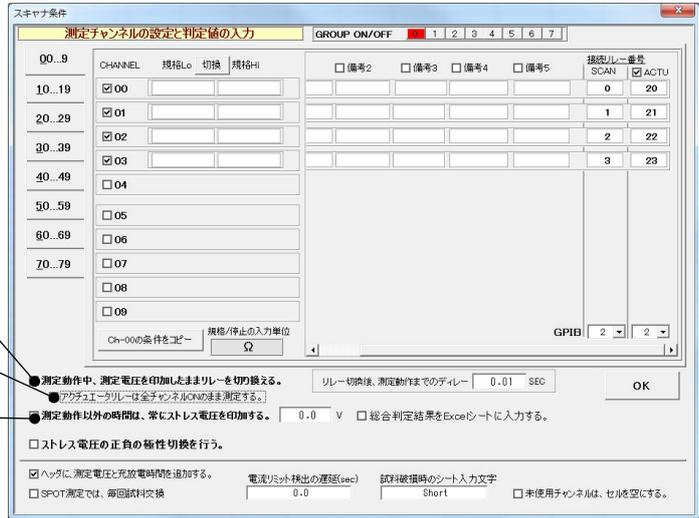
測定を行っていない時間帯でも、試料にストレス電圧を印加しつづけます。測定電圧とストレス電圧が同じ場合は、ここに測定電圧と同じ電圧値を入力します。
