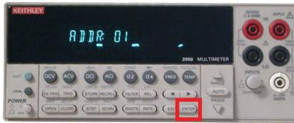
測定器のラングエッジを「SCPI」に設定し「ENTER」ボタンで確定します。
