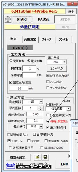
4 探針測定を行うためには、本ソフトを4探針測定モードに切替えます。
