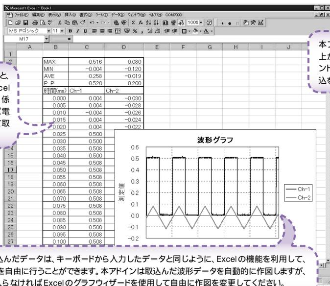
本プログラムはExcel上のアドインとして動作します。Excel上から本アドインを起動すると、Excelシート上に、このウィンドウが現われます。「波形取込」ボタンで波形データの取込を開始します。
