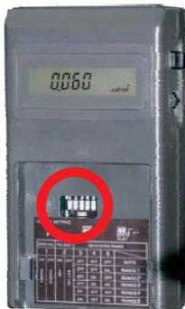
本ソフトを使用して、輝度計からのデータ取得するためには、必ず、輝度計本体のディップスイッチ「2」をONに設定し、RS232C通信をUSEにしてください。詳細は、輝度計付属の取 説明書を参照ください。
