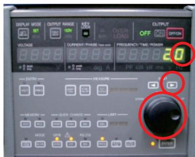
次に「右矢印」ボタンを押し、数値の点滅を小数点の右へ移動します。ロータリーノブをまわして「0」に設定します。「0」はデリミタ「CR+LF」を意味します。「ENTER」キーで設定を終了します。
