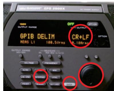
さらに「INTERFACE」ボタンを押すと、パネルに「GP-IB DELIM」が表示されます。ロータリーノブを回して、「CR+LF」を選択します。「ENTER」キーで設定を完了します。
