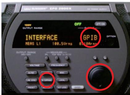
「INTERFACE」ボタンを1回押すと、パネルに「INTERFACE」が表示されます。ロータリーノブを回して、「GP-IB」を選択します。
