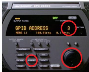
もう一度「INTERFACE」ボタンを押すと、パネルに「GP-IB ADDRESS」が表示されます。ロータリーノブを回して、任意の値を選択します。
