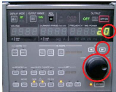
次に「右矢印」ボタンを押し、数値の点滅を小数点の右へ移動します。ロータリーノブをまわして「0」に設定します。「0」はデリミタ「CR+LF」を意味します。「ENTER」キーで設定を終了します。
