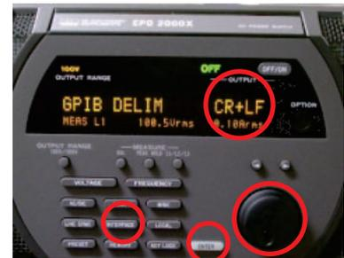
さらに「INTERFACE」ボタンを押すと、パネルに「GP-IB DELIM」が表示されます。ロータリーノブを回して、「CR+LF」を選択します。「ENTER」キーで設定を完了します。
