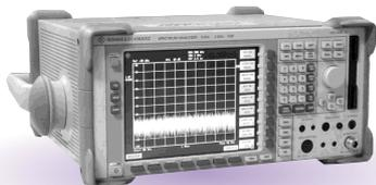
1. 画面上の「スペクトル波形」「Max Peak」「Next Peak」「測定条件」をExcelシートに取込み、必要なら自動的に作図を行います。
