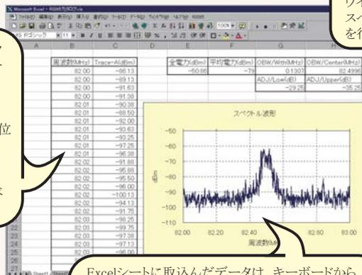
Excelシートに取込んだデータは、キーボードから入力したデータと同じように、Excelの機能を利用して、作図・編集・計算等を自由に行うことができます。本アドインは取込んだスペクトル波形を自動的に作図しますが、作図形式が気に入らなければExcelのグラフィックガイドを使用して自由に作図を変更してください。
