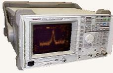
画面上の「スペクトル波形」「Max Peak」「Min Peak」をExcelシートに取込み、必要なら自動的に作図を行います。
