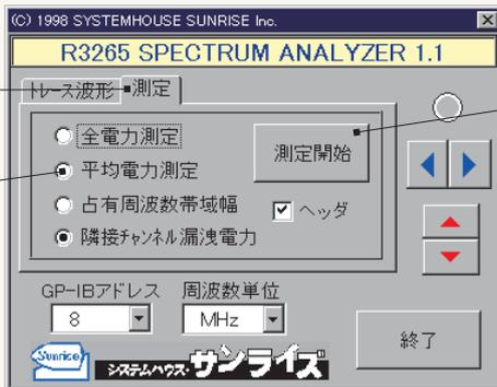
チェックを付けた項目の測定を開始し、その結果を取込みます。各項目の測定に必要な条件は、事前にR3265の操作パネルから手動で設定しておいてください。本アドインは、測定開始とその結果を取込むだけです。パワー(電力)の測定ではR3265に事前に設定されたアベレージ回数のスイープを完了後、その結果をExcelシートに取込みます。
