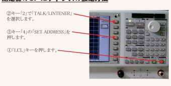
④キー「1」で、測定器のGP-IBアドレスを設定します。
