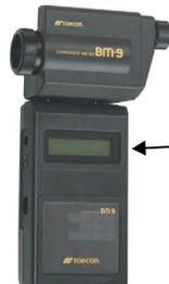
BM-9用専用ケーブルを使用して、パソコンのRS-232Cに接続します。
