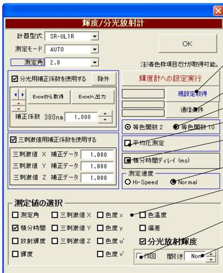
輝度計本体の現在の設定条件を読み込み表示します。
