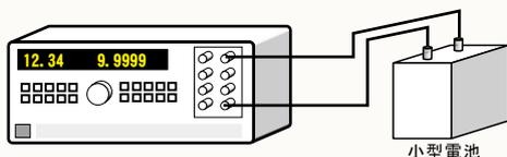
小型電池の充電試験、または放電試験を行います。また、電子部品や素子の経時変化の評価に使用できます。
