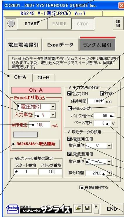
「出力番地」で設定された範囲のデータのランダムスイープを開始します。「取込開始」でデータを取り込んだ時の下記の条件を変更してはいけません。
