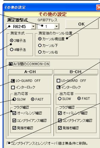
測定後、自動的にExcel上のカーソルを、次のデータ取り込み位置へすすめます。新しい測定値が、前の測定データに上書きしないようにするために使用します。電圧掃引とランダム掃引の時に機能します。
