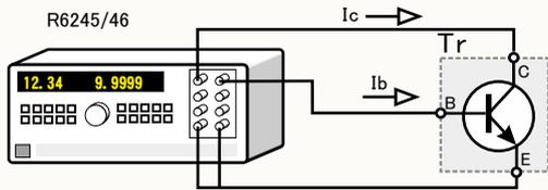
トランジスタのベース電流スイープに同期して、コレクタ電流を測定する例です。
