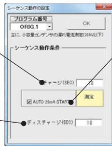
測定レンジが、AUTO-RANGEに設定されている時、測定直前に、一旦、20mAレンジに設定し、その後、AUTO-RANGEに戻してから、測定を行います。測定レンジが、AUTOではない場合、この設定は無視されます。
