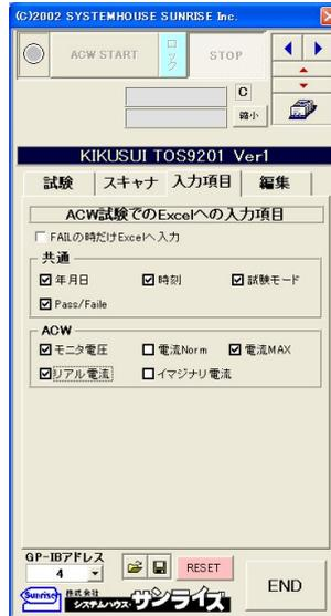
試験結果をExcelシートに取り込む必要がある場合は、ここで、その項目を選択します。「共通」は、全ての試験に共通の項目です。ここでの変更は、他の試験に反映されません。「ACW」は、AC耐压試験独自の項目です。
