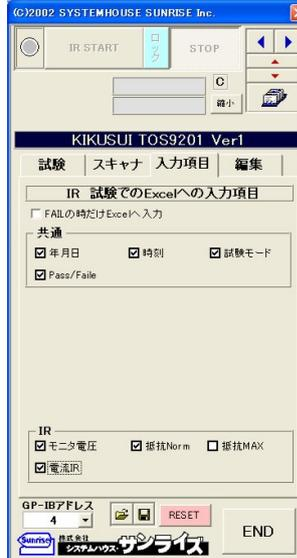
試験結果をExcelシートに取り込む必要がある場合は、ここで、その項目を選択します。「共通」は、全ての試験に共通の項目です。ここでの変更は、他の試験に反映されます。「ACW」は、AC耐圧試験独自の項目です。
