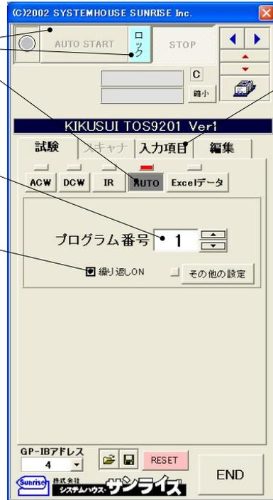
試験結果をExcelシートに取り込む必要がある場合、「入力項目」タブを選択し、入力項目を設定します。(下記図参照)※7
