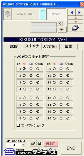
スキャナの接続条件を設定します。スキャナの接続されていない試験器では、ここでの設定は無視されます。
