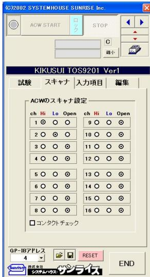
スキャナの接続条件を設定します。スキャナの接続されていない試験器では、ここの設定は無視されます。
