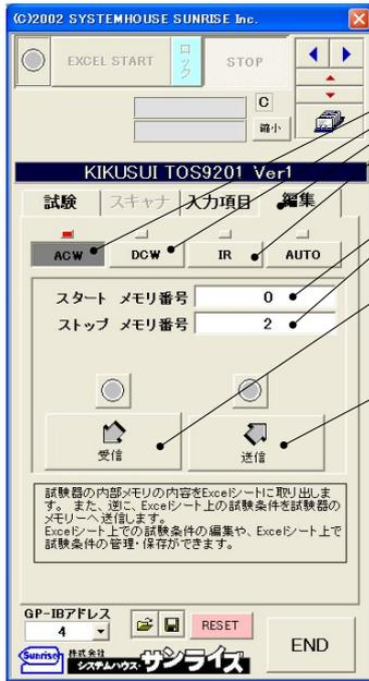
「ACW」「DCW」または「IR」の試験器内のメモリデータを編集するためには、「編集」タブを選択し、次に、希望する試験項目ボタンを押します。
