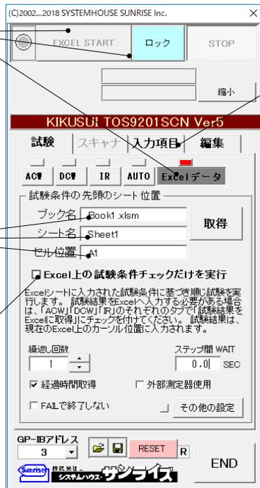
試験結果をExcelシートに取り込む必要がある場合、「入力項目」タブを選択し、入力項目を設定します。ここでの設定は、「ACW」「DCW」「IR」各項での設定がそのまま反映されます。従いまして、全ての項目をExcelシートに入力するためには、「ACW」「DCW」「IR」の各タブの「試験結果をExcelに取得」にチェックが付いている必要があります(下記図参照)
