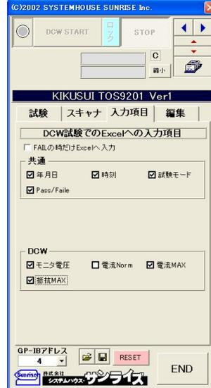
試験結果をExcelシートに取り込む必要がある場合は、ここで、その項目を選択します。「共通」は、全ての試験に共通の項目です。ここでの変更は、他の試験に反映されます。「DCW」は、DC耐圧試験独自の項目です。
