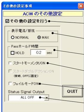
試験開始と同時に、ここでの設定条件を試験器に設定します。チェックを外すと、設定を行わないため、現在の設定が維持されます。
