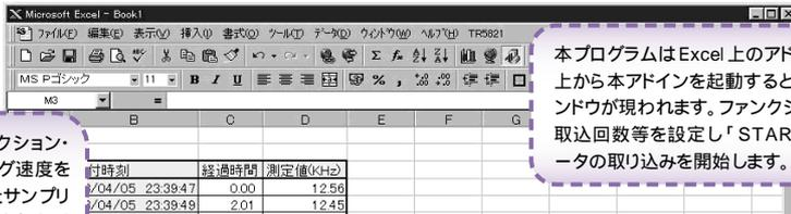
本プログラムはExcel上のアドインとして動作します。Excel上から本アドインを起動すると、Excelシート上に、このウィンドウが現われます。ファンクション、測定レンジ、時間間隔、取込回数等を設定し「START」ボタンをクリックするとデータの取り込みを開始します。
