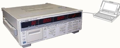
指定された時間間隔で指定された数の電圧・電流・ワット・周波数等の全ての測定項目のデータを直接Excelのシートに取込みます。
